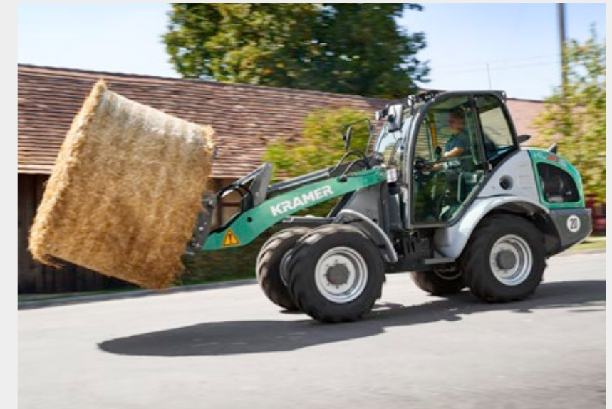
Krmiljenje s prednjo osjo za boljšo stabilnost med hitrimi prevozi
