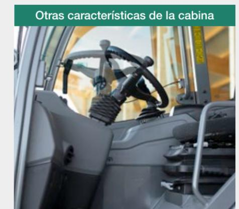
El extenso equipamiento de serie comprende, por ejemplo, un volante de inclinación regulable que se puede ajustar a cada conductor. Asimismo, el espejo interior y la luz de trabajo ofrecen un campo de visión óptimo. El vehículo se puede equipar opcionalmente con un asiento para el operador con suspensión neumática, soporte lumbar y calefacción.
