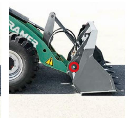
**Enganche rápido hidráulico - El sistema de cambio rápido de Kramer:** acercarse al accesorio, recogerlo desde el asiento del operador de forma hidráulica y bloquearlo pulsando un botón en el joystick. El cilindro de bloqueo se encuentra fuera del punto de pivote de la placa del sistema de cambio rápido y, por tanto, fuera de la zona donde puede ensuciarse.
