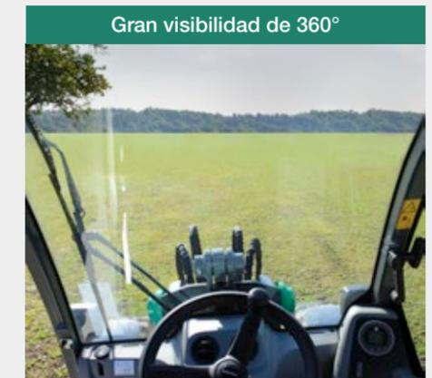
La posición central del asiento junto con las grandes superficies acristaladas ofrece una visión panorámica de 360°. El diseño excepcionalmente claro y la posición del asiento del conductor evitan los «ángulos muertos». La visibilidad trasera también es completa. El parabrisas elevado permite también una visibilidad perfecta del accesorio incluso cuando el brazo está en su posición más alta.
