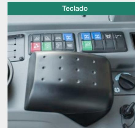
Gracias a los interruptores codificados por colores, cada grupo de funciones puede reconocerse rápidamente. Rojo = seguridad, verde = hidráulica, azul = conducción y gris = sistema eléctrico. De esta forma, se garantiza al conductor un funcionamiento cómodo y seguro sin riesgo de confusiones. El resultado es una mayor eficiencia en el trabajo.
