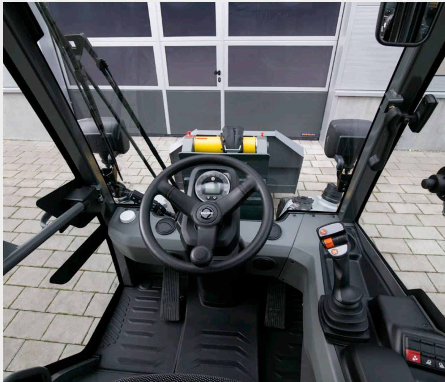
Komfortabelt joystick: Der kan skiftes direkte mellem Hare og Skildpadde på joysticket.
