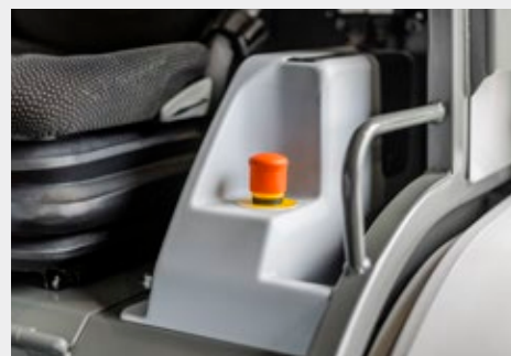
Let tilgængelig nødstopkontakt, så maskinen i tilfælde af fare øjeblikkeligt kan bringes til en sikker tilstand.
