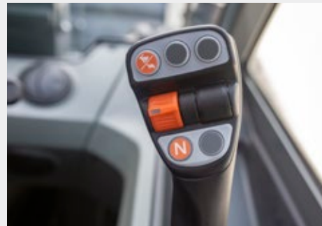
Komfortabelt joystick: Der kan skiftes direkte mellem Hare og Skildpadde på joysticket.
