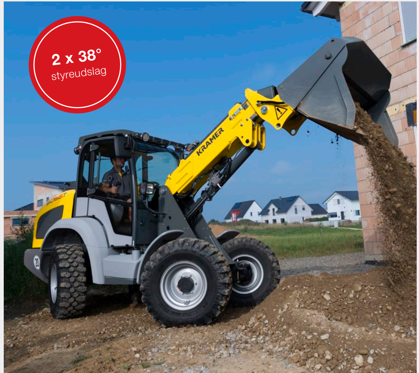
Firehjulsstyring: særligt manøvreedygtig ved trange pladsforhold
