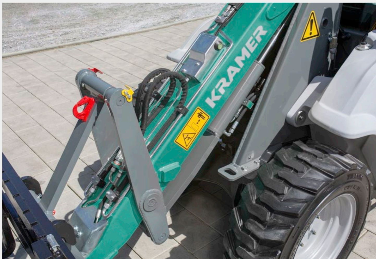
Robustna enota nakladača z Z-kinematiko, prikazovalnikom položaja in opsijskim dvižnim kavljem.
