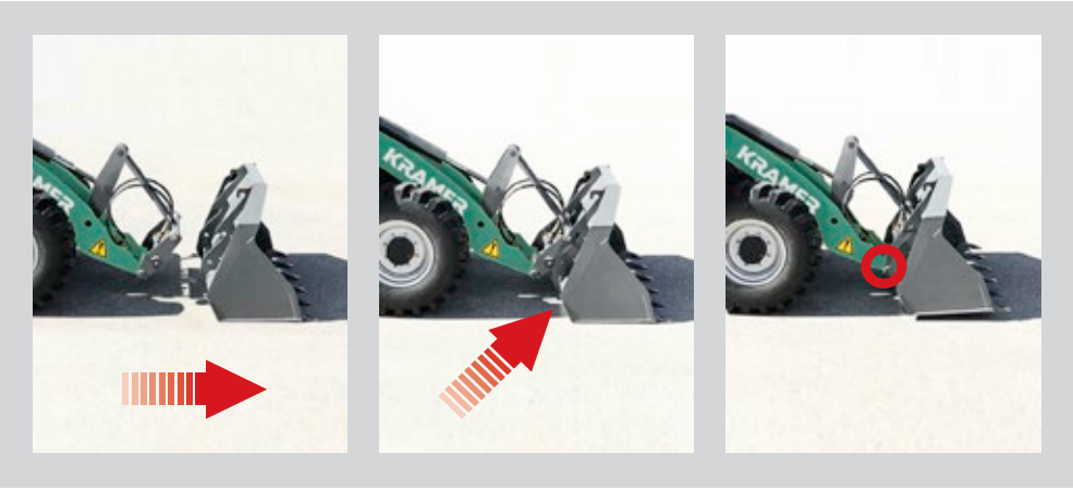
Wymiana osprzętu zawsze w kilka sekund dzięki hydraulicznie ryglowanej ramce narzędzi.
