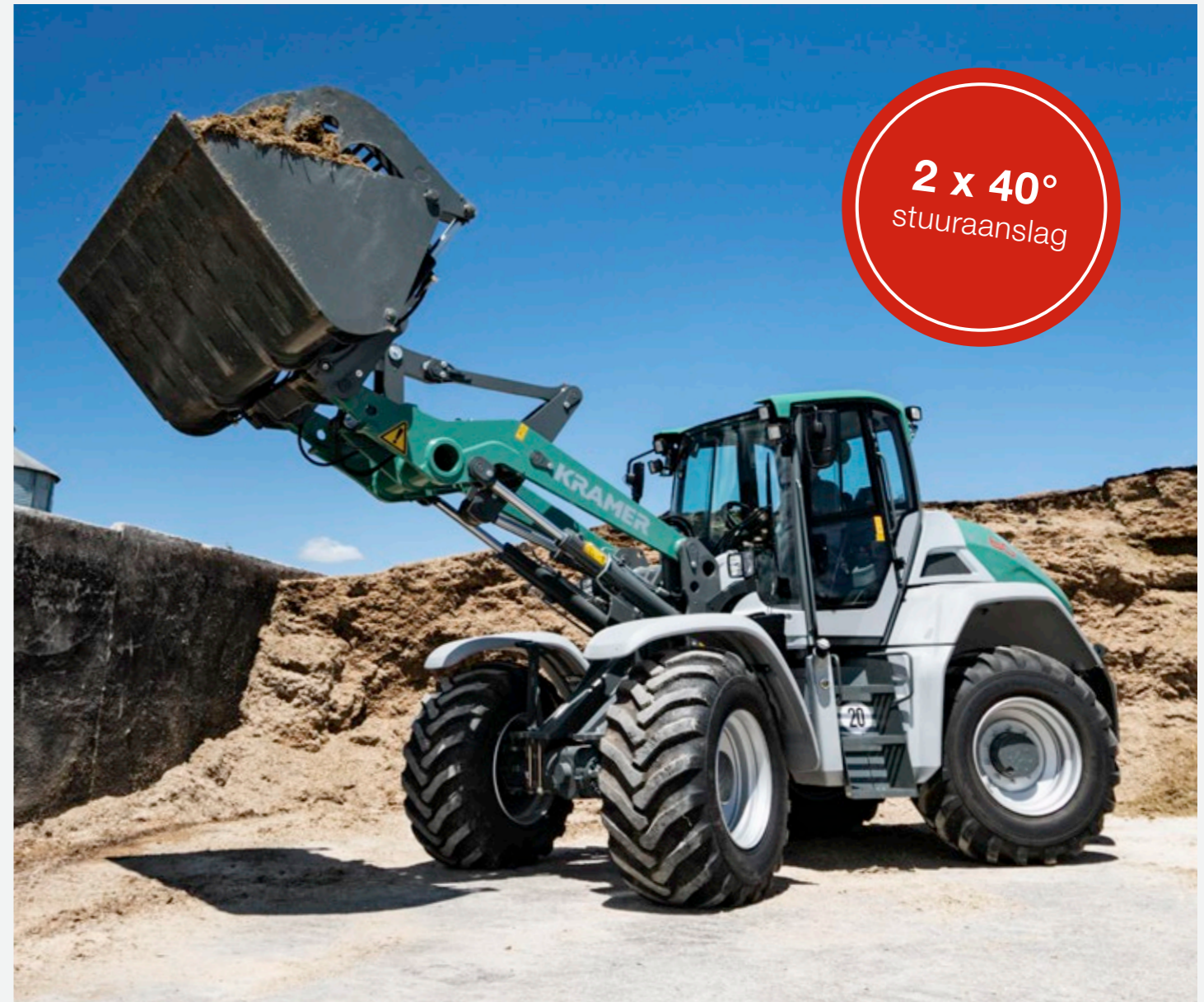
Vierwielbesturing bijzonder wendbaar bij beperkte plaats
