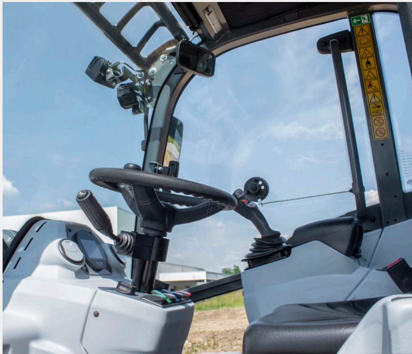
Hytt med glas runt om för optimal sikt åt alla håll.
