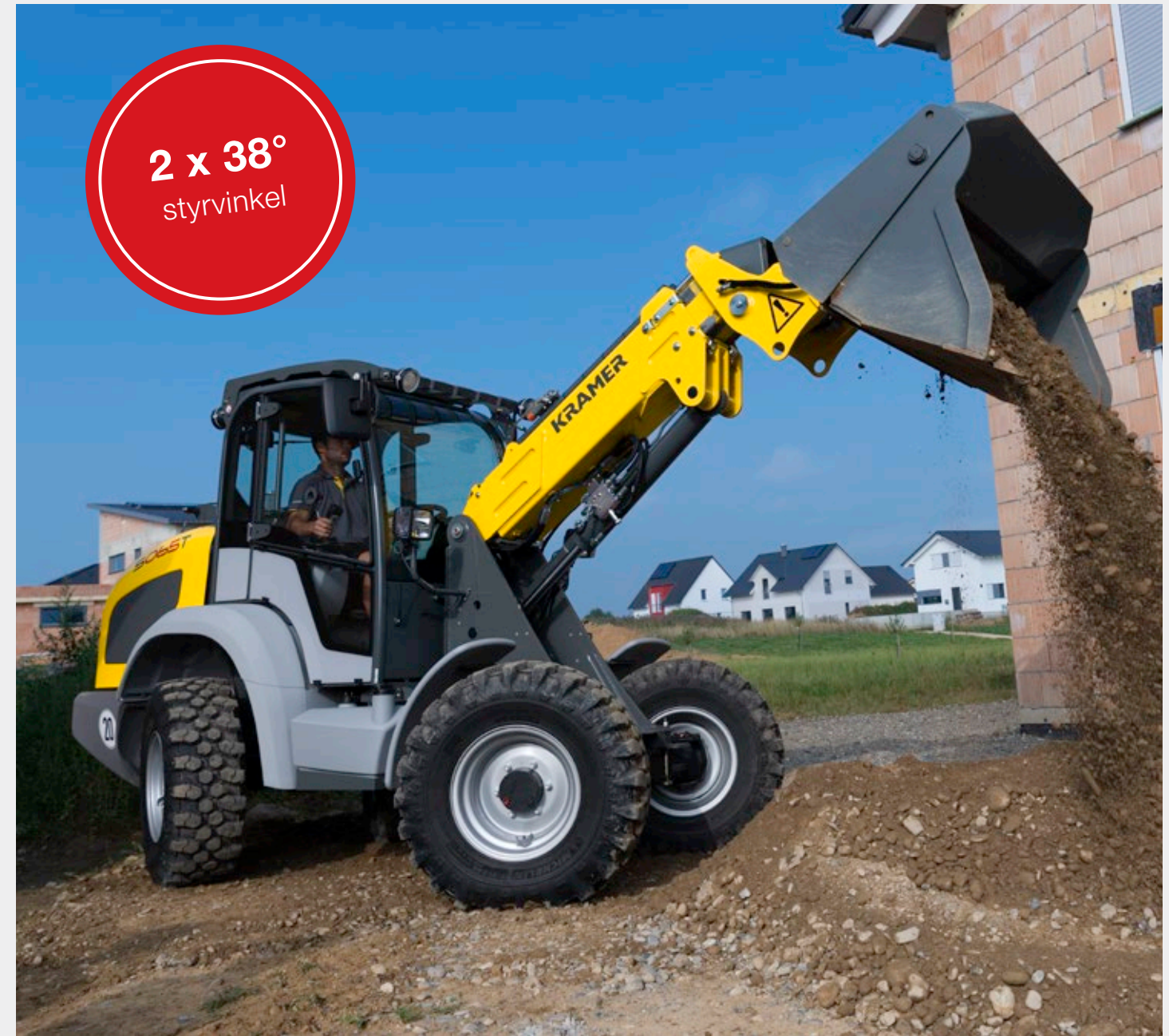
Fyrhjulsstyrning: Särskilt rörlig vid begränsat utrymme
