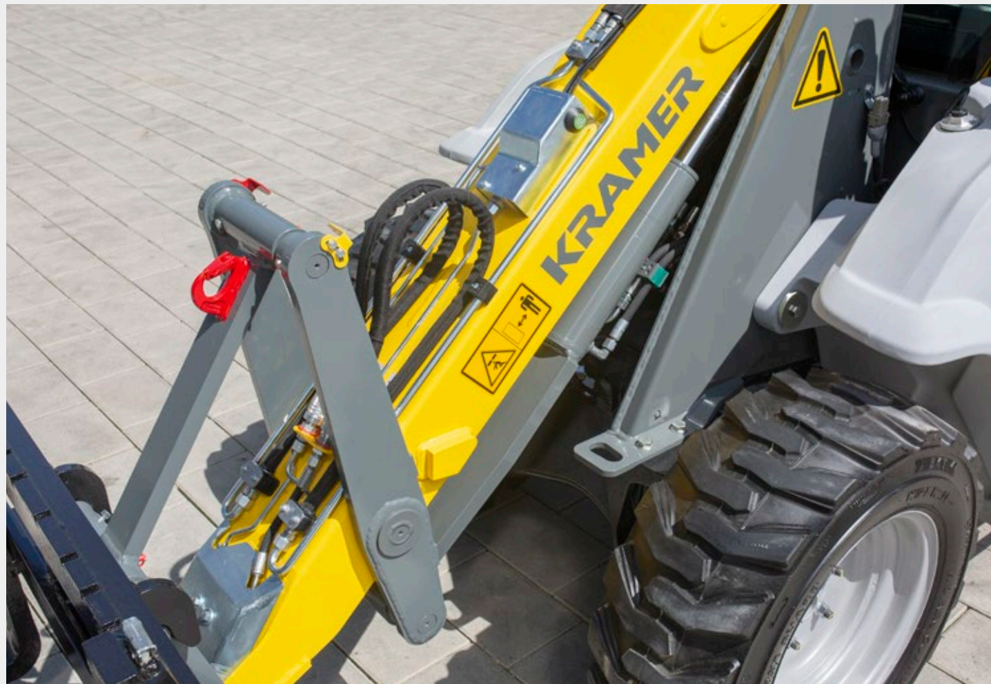
Robust lastsystem med Z-kinematik, visuell positionsvisning och lastkrokar som tillval.
